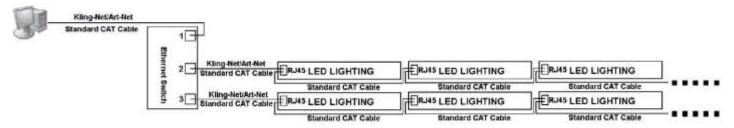
Note: le Switch ETHERNET doit avoir une vitesse minimale d'1 Gigabit (1000mbps).
